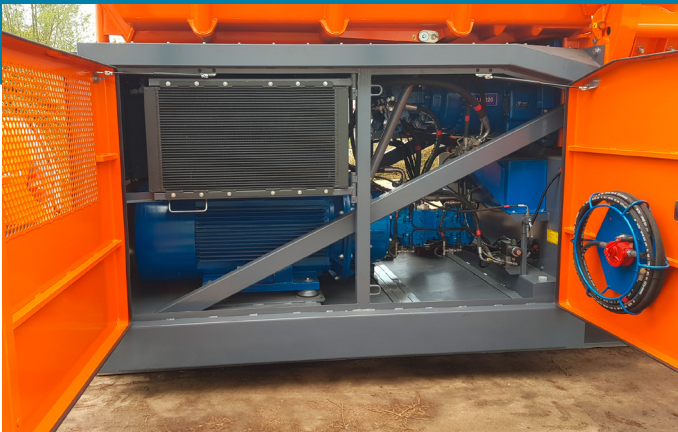
Innenansicht des neuen strombetriebenen Schredders
