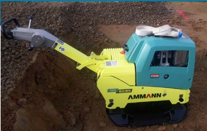
Moderne Rüttelplatte mit einem effizienten Benzinmotor im Einsatz.
