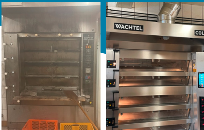
Alter Ofen (links), neuer, energieeffizienter Gas-Etagenbackofen (rechts).
